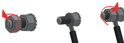
Rys. 4. Podłączenie urządzenia do instalacji wyrównującej potencjały elektryczne.
