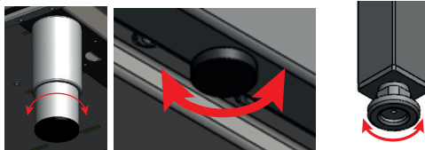
Figura 3. Nivelación del dispositivo
