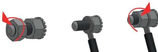
Figura 4. Conexión del equipo a una instalación equipotencial.
