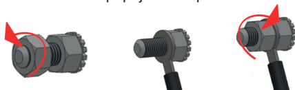
Obrázek č. 4. Připojení přístroje k zařízení pro vyrovnávání potenciálu.
