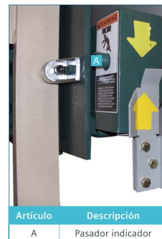
Figura 44: Montacargas manual acoplado (observe la posición del pasador indicador)
