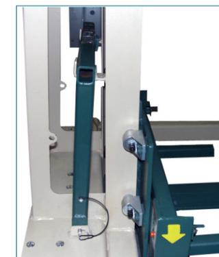
Figura 57: Almacenamiento del adaptador de bandeja auxiliar en el montacargas manual
