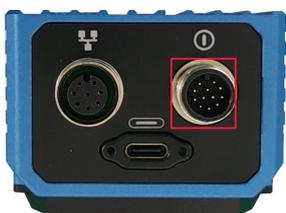
2. 断开设备电源，保持长按TRIG按键，对设备重新上电，设备会自动进入烧录模式。
