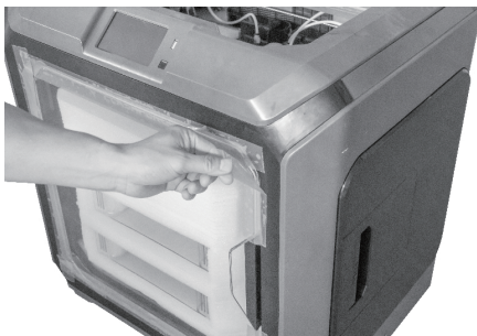
8. 移除固定打印机前门的胶带。
