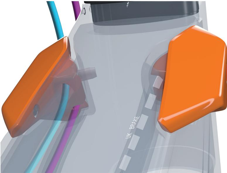
Soll die Hinterradbremse über den linken Bremshebel angesteuert werden (Großbritannien), bitte die Kabelführung auf der Antriebsseite des Steuerrohrs verwenden (durch die gestrichelten Linien gekennzeichnet).
