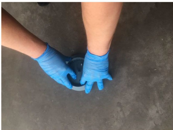
Figura 8 Fixarea bazei senzorului
