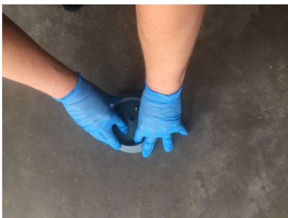
Εικόνα 8 Προσάρτηση βάσης αισθητήρα
