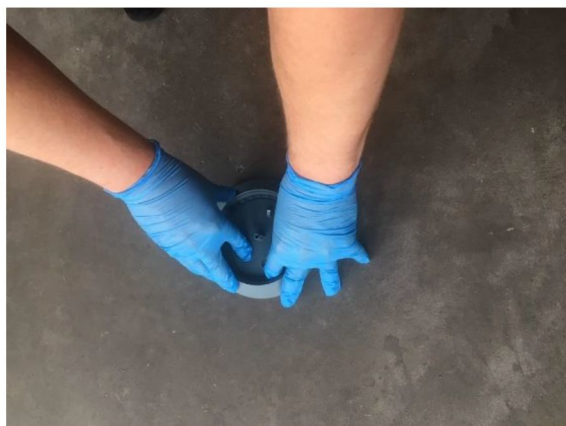
Figura 8 Fixação da base do sensor
