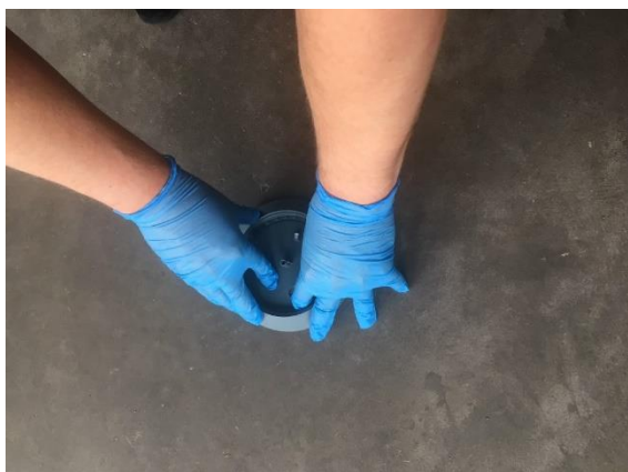
Illustration 8 Fixation du socle du capteur
