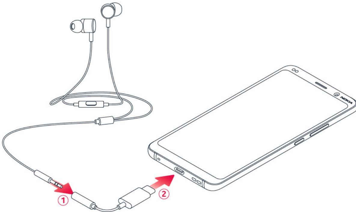
Ihr Telefon besitzt einen USB-C-Audioausgang. Sie können ein Headset mit handelsüblichem 3,5-mm-Stecker mit Ihrem neuen Telefon verwenden: Schließen Sie einfach das Headset an den Adapter im Lieferumfang des Telefons an und stecken Sie die USB-Seite des Adapters in Ihr Telefon.
