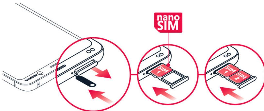
1. Öffnen Sie das SIM-Kartenfach: Setzen Sie den Öffnerstift in die Vertiefung des Fachs, und ziehen Sie das Fach heraus.
