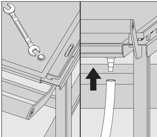
En el lado derecho de la bandeja de recogida se encuentra una boquilla de desagüe. En el estado de suministro, las boquillas de desagüe están cerradas con un tornillo ciego.
