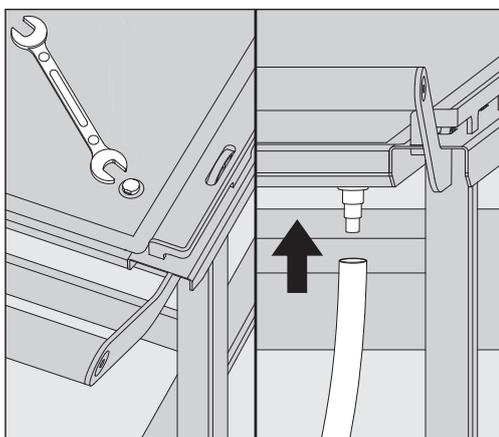
Справа в піддоні розміщений зливний штуцер. На момент поставання зливний штуцер закрито сліпим гвинтом.
