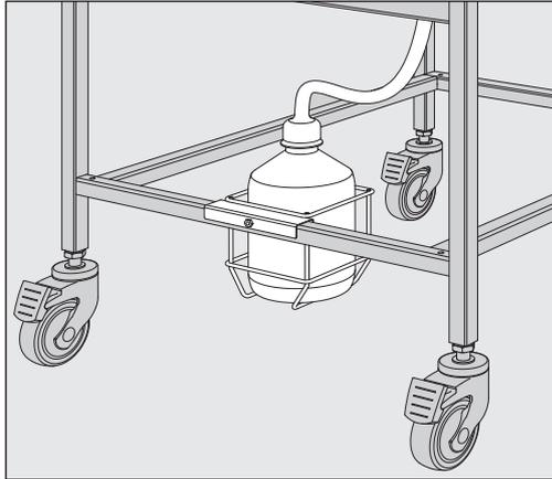
Akış kanalının altındaki desteğe sıvı birikme haznesi için bir tutucu (sonradan satın alınabilen aksesuar) takılabilir.
