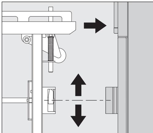
Die Höhe des Transferwagens ist an den Laufrollen einstellbar. Die Höhe muss so eingestellt sein, dass die Andockvorrichtungen von Transferwagen und Reinigungsautomat ineinandergreifen.
