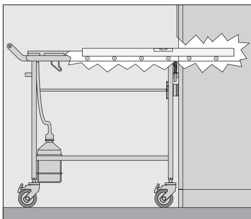
Die Transportrollen auf dem Transferwagen und im Reinigungsautomaten müssen auf gleicher Höhe liegen, damit sich die Beladungsträger leicht verschieben lassen.
