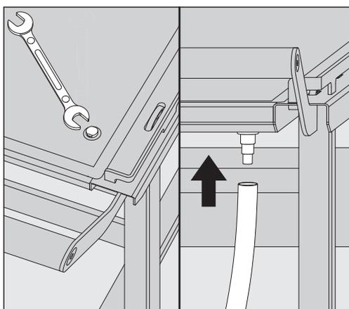
排水接続はドリップトレイの右側にあります。納入時の状態では、機器の排水接続を遮断するブラインドストッパーが設けられています。
