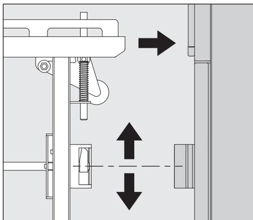
Výška přepravního vozíku se nastavuje na přepravních kolečkách. Výška musí být nastavená tak, aby do sebe zapadla přípojná zařízení přepravního vozíku a mycího a dezinfekčního automatu.
