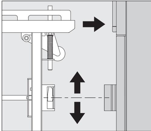
De hoogte van de transferwagen kan met de zwenkwieltjes worden ingesteld. De hoogte moet zo worden ingesteld dat de koppelmecanismen van de transferwagen en de reinigingsautomaat in elkaar grijpen.
