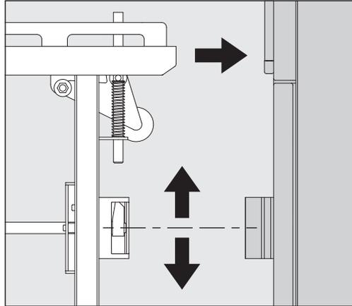
La hauteur du chariot de transfert peut être réglée sur les roulettes. La hauteur doit être réglée de telle sorte que les dispositifs d'accrochage du chariot de transfert et du laveur s'agrippent l'un dans l'autre.
