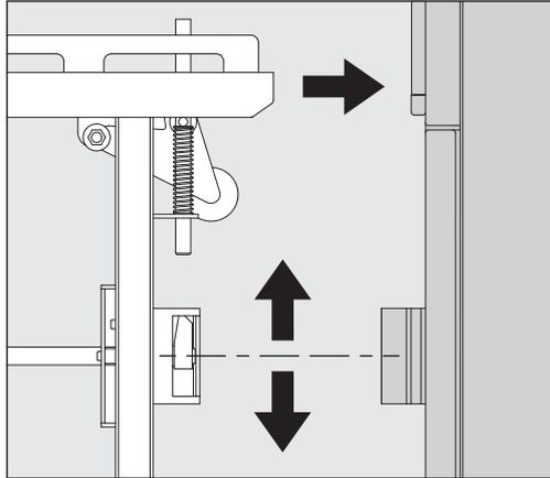
Kuljetusvaunun korkeutta voidaan säätää sen pyörien avulla. Korkeus on säädettävä siten, että kuljetusvaunun ja desinfiointikoneen telakointiliitännät osuvat kohdakkain.
