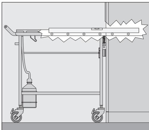
Os rolos de transporte no carro de transporte e na máquina de lavar e desinfetar devem estar à mesma altura para que os suportes de carga possam ser facilmente deslocados.
