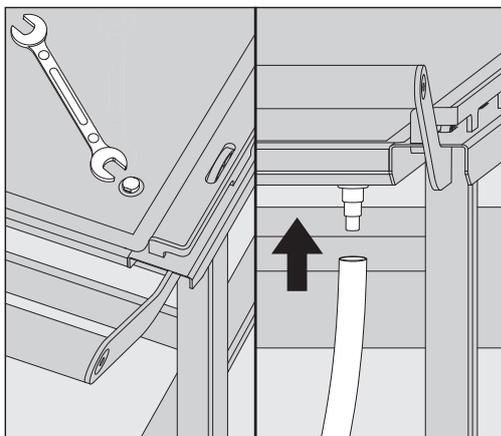
Po prawej stronie tacy ociekkowej znajduje się króciec odpływowy. W stanie fabrycznym króciec odpływowy jest zamknięty śrubą zaślepiającą. Króciec odpływowy może zostać połączony węzłem z butlą zlewową.
