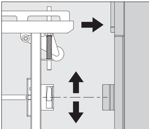
Høyden på transporttrallen kan stilles inn på hjulene. Høyden må justeres slik at tilkoblingsinnretningene på transporttrallen og rengjøringsautomaten griper inn i hverandre.
