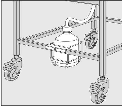
På vagen under afløbsstudsens kan der anbringes en holder til en opsamlingsflaske (ekstra tilbehør).
