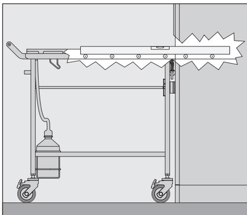
Transporthjulene på transporttrallen og i rengjøringsautomaten må ligge i samme høyde, slik at det er enkelt å skyve vognen, kurven osv.
