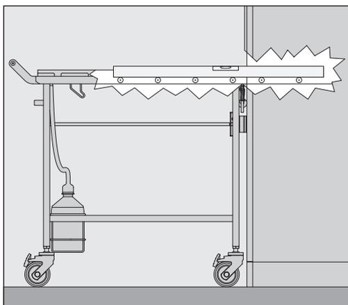
Транспортировочные ролики на транспортировочной тележке и в автомате для мойки должны располагаться на одной высоте, чтобы грузочные тележки можно было легко передвинуть.
