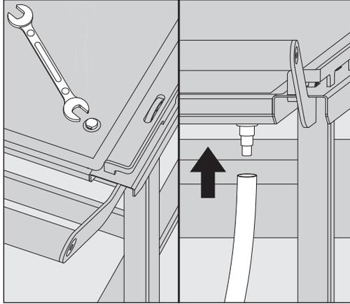
Damlama tepsisinin sağ tarafında bir akış kanalı bulunur. Transfer arabası, akış kanalı kör bir vidayla kapatılmış bir şekilde teslim edilir. İstenirse akış kanalı, hortum yardımıyla bir sıvı birikme haznesine bağlanabilir.
