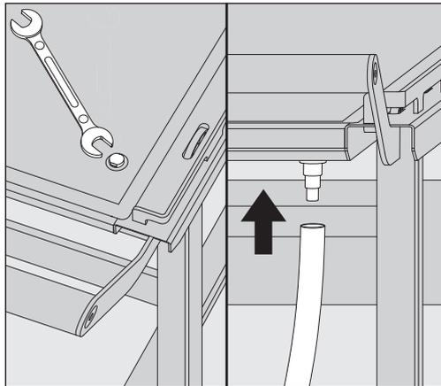
Keruuastian oikeassa reunassa on poistoliitântä. Poistoliitântä on tehtaalla suljettu sulkuruuvilla.
