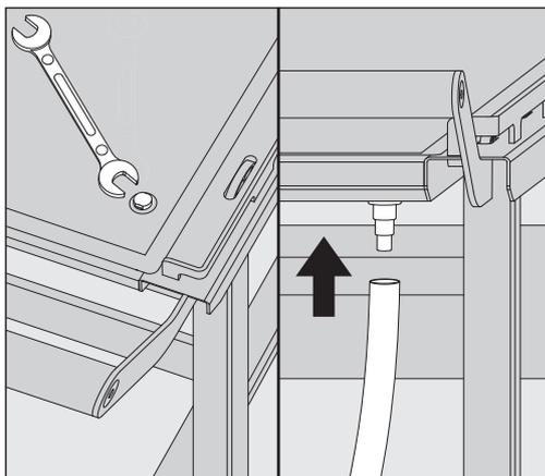
No lado direito do tabuleiro aparta-pingos encontra-se um bocal de descarga. Aquando da entrega, o bocal de descarga está tapado com um parafuso falso.
