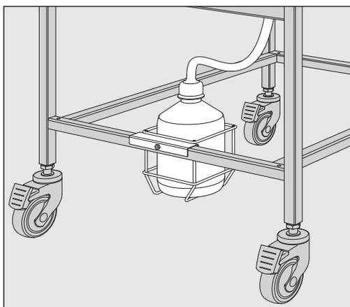
Ένα στήριγμα για φιάλη περισυλλογής (πρόσθετο εξάρτημα) μπορεί να τοποθετηθεί στον βραχίονα κάτω από το στόμιο αποστράγγισης.
