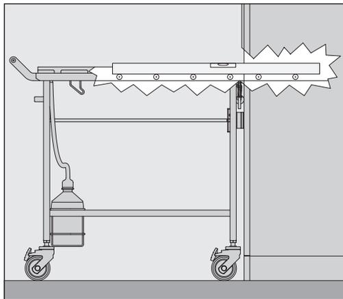
De transportrollen op de transferwagen en in de reinigingsautomaat moeten zich op dezelfde hoogte bevinden, zodat de beladingssystemen gemakkelijk kunnen worden verschoven.
