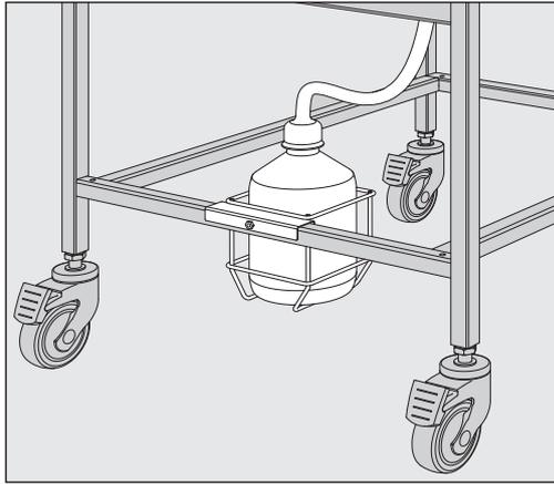
可为滴漏瓶连接固定器（配件单独出售）以在废水接口下方起支撑作用。
