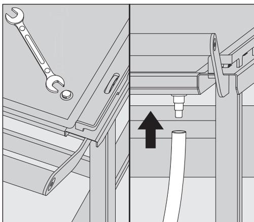
Der er en afløbsstuds i højre side af opsamlingsbakken. Ved levering er afløbsstudsens lukket til med en blindskrue.
