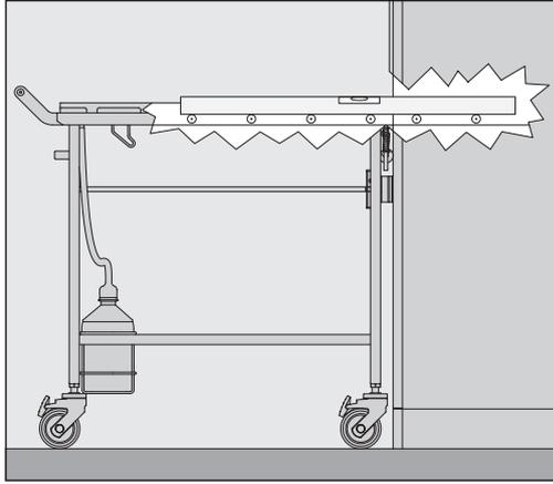
Yük taşıyıcılarının kolayca itilebilmesi için transfer arabası üzerindeki aktarım makaraları ile yıkama makinesindeki aktarım makaralarının aynı yükseklikte bulunması gerekir.
