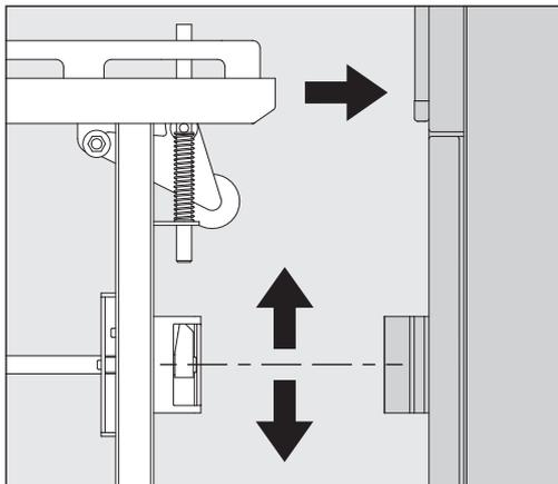
運搬トロリーの高さは車輪で調節できます。高さは、運搬トロリーと機器のドッキングメカニズムがかみ合うように設定する必要があります。
