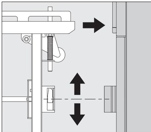
A altura do carro de transporte é regulável nas rodas. A altura deve ser regulada de tal forma que os dispositivos de encaixe do carro de transporte e máquina de lavar e desinfetar engatem.
