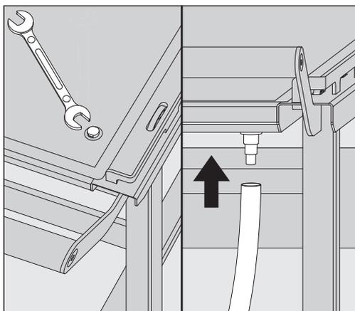
Sul lato destro della vaschetta di raccolta si trova un bocchettone di scarico. Di serie il bocchettone di scarico è chiuso con una vite cieca. Il bocchettone di scarico può essere collegato a un contenitore di raccolta con un tubo.
