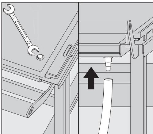
废水接口位于滴漏盘的右侧。当设备处于交付状态时，有一个盲塞会将废水接口关闭。
