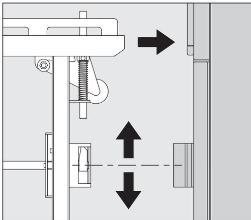
可在车轮处对转运车高度进行调整。必须设定高度，以便转运车和机器的对接机制接合。
