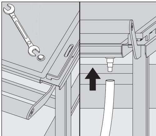
An der rechten Seite der Auffangschale befindet sich ein Ablaufstutzen. Im Auslieferungszustand ist der Ablaufstutzen mit einer Blindschraube verschlossen.
