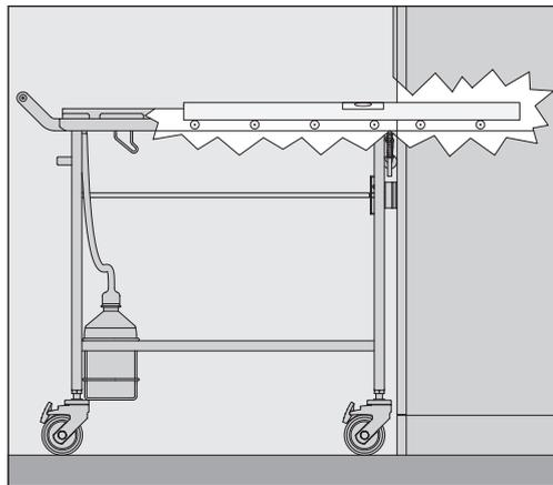
Les roulettes de transport sur le chariot de transfert et dans le laveur doivent être à la même hauteur, pour que les compléments puissent facilement être déplacés.
