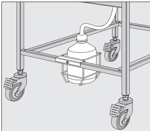
На распорке под сливным штуцером можно разместить крепление для приёмной ёмкости (дополнительно приобретаемые принадлежности).
