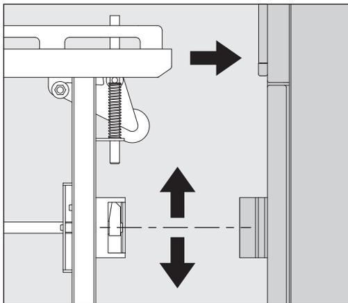
Se puede ajustar la altura del carro de transporte en las ruedas. La altura deberá ajustarse de forma que los dispositivos de anclaje del carro de transporte y de la lavadora desinfectadora agarren entre sí.
