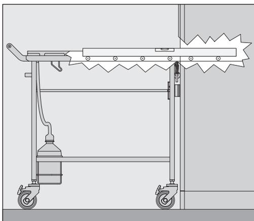
Οι κύλινδροι μεταφοράς στο τρόλεϊ μεταφοράς και στην αυτόματη συσκευή καθαρισμού πρέπει να βρίσκονται στο ίδιο ύψος, ώστε να είναι δυνατή η εύκολη μετακίνηση των βάσεων φόρτωσης.
