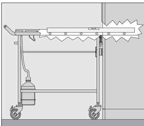
转运车上以及机器中的传送机滚轴必须高度相同，以便可轻松移动负载载体。
