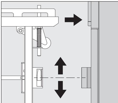
Výška prepravného vozíka sa nastavuje na prepravných kolieskach. Výška musí byť nastavená tak, aby do seba zapadlo prípojné zariadenie prepravného vozíka a umývacieho a dezinfekčného automatu.
