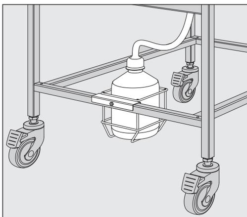
En el tirante que se encuentra debajo de la boquilla de desagüe se puede colocar un soporte para un recipiente de recogida (accesorio opcional).
