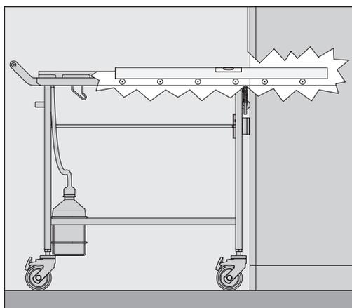
Přepravní kolečka na přepravním vozíku a v mycím a dezinfekčním automatu musí být ve stejné výšce, aby se snadno daly přesouvat mycí koše.
