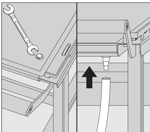
På uppsamlingskärlets högra sida finns det en avloppsanslutning. I leveransutförande är avloppsanslutningen stängd med en blindskruv. Avloppsanslutningen kan kopplas till en uppsamlingsflaska med en slang.
