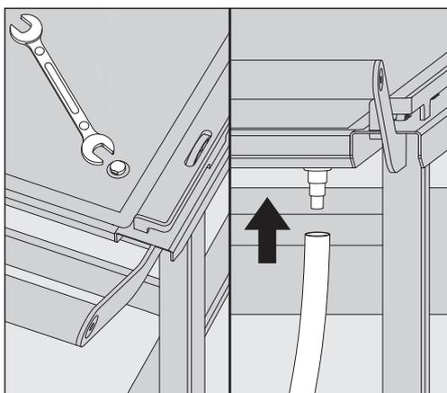
С правой стороны поддона находится сливной штуцер. В состоянии поставки сливной штуцер закрыт заглушкой. Сливной штуцер с помощью шланга может быть соединён с приемной емкостью.
