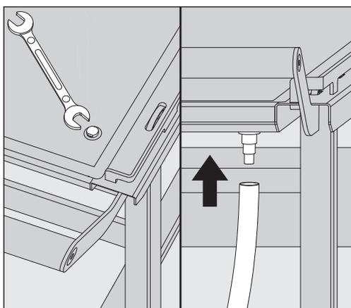
Sur le côté droit du bac de récupération se trouve un raccord d'écoulement. A la livraison, le raccord d'écoulement est obturé à l'aide d'une vis d'obturation.
