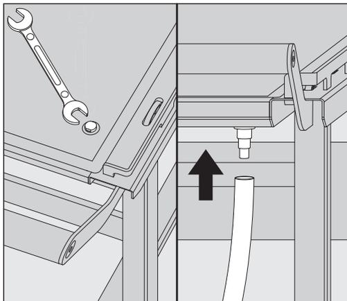
Na pravé straně záchytné misky se nachází vypouštěcí hrdlo. Ve stavu při expedici od výrobce je vypouštěcí hrdlo uzavřené zaslepovacím šroubem.
