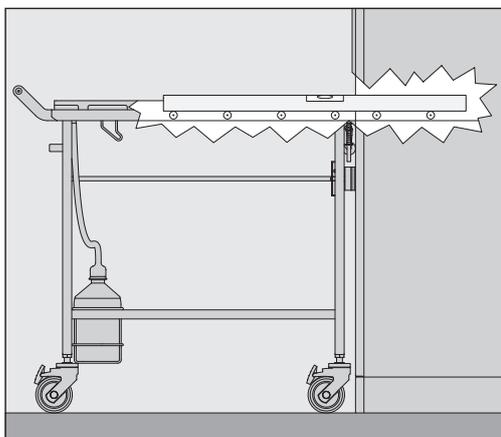
運搬トロリーおよび機器に搭載されている各コンベアローラーは、ロードキャリアを簡単に移動できるように同じ高さにする必要があります。
