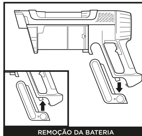
REMOÇÃO DA BATERIA
