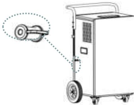
Steek een waterslang met een binnendiameter van 5 mm in de afvalwateraansluiting van de pomp (toegang is mogelijk onder elke hoek).
