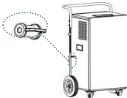
Do prípojky odpadovej vody čerpadla zasuňte vodnú hadicu s vnútorným priemerom 5 mm (prístup je možný pod akýmkolvek uhlom).
