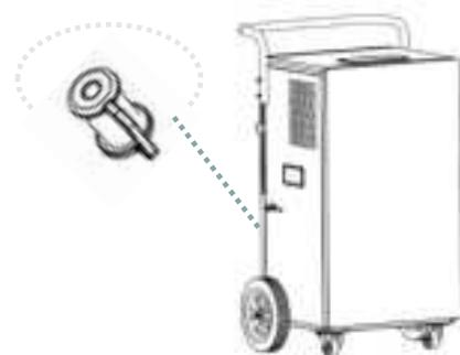
K prípojke odpadovej vody pripojte odpadovú hadicu s vnútorným priemerom 12 mm.
