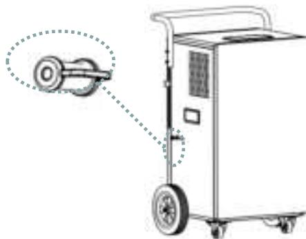
Führen Sie ein Wasserschlauch mit einem Innendurchmesser von 5 mm in den Abwasseranschluß der Pumpe ein (der Zugang ist in einem beliebigen Winkel möglich).
