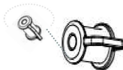
Sluit een afvalwaterslang met een binnendiameter van 12 mm aan op de afvalwaternaansluiting.
