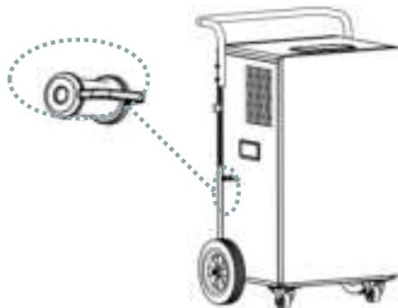
Introduzca una manguera de agua con un diámetro interior de 5 mm en la conexión de aguas residuales de la bomba (el acceso es posible en cualquier ángulo).
