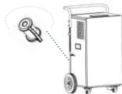
K přípojce odpadní vody připojte odpadní hadici o vnitřním průměru 12 mm.
