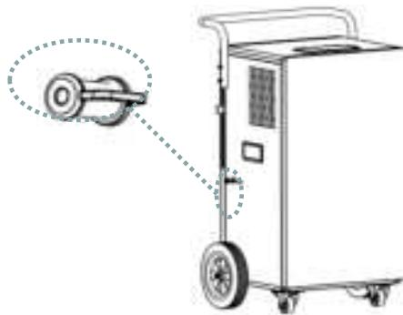
Introduceți un furtun de apă cu un diametru intern de 5 mm în racordul de apă uzată al pompei (accesul este posibil din orice unghi).
