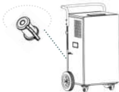
Collegare un tubo flessibile per l'acqua di scarico con un diametro interno di 12 mm all'attacco dell'acqua di scarico.
