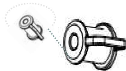
Spojite crijevo za otpadnu vodu unutarnjeg promjera 12 mm na priključak za otpadnu vodu.
