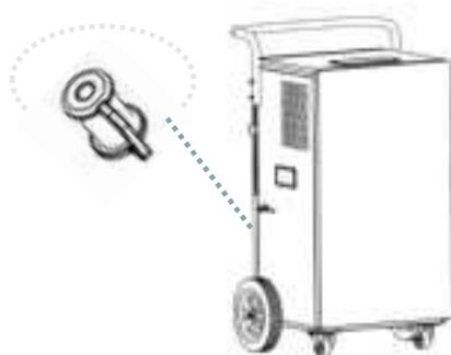
Conectați un furtun de apă uzată cu un diametru interior de 12 mm la racordul de apă uzată.
