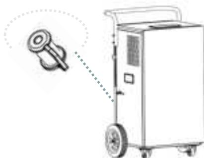
Podłącz wąż odpływowy o średnicy wewnętrznej 12 mm do przyłącza odpływowego.
