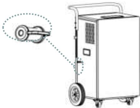
Introduisez un tuyau d'eau d'un diamètre intérieur de 5 mm dans le raccord d'évacuation de la pompe (l'accès est possible sous n'importe quel angle).
