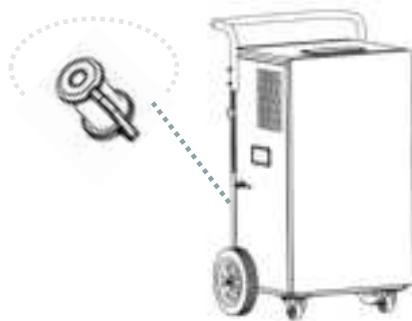
Schließen Sie ein Abwasserschlauch mit 12 mm Innendurchmesser an den Abwasseranschluß an.
