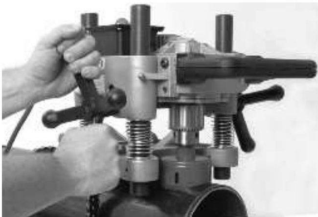
Εικόνα 11 – Χειρισμός του μηχανήματος διάτρησης σωλήνων
