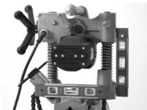
Figura 10 – Nivelación de la HC-300
