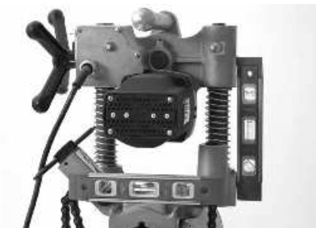
Figura 10 – Nivelamento da HC-300
