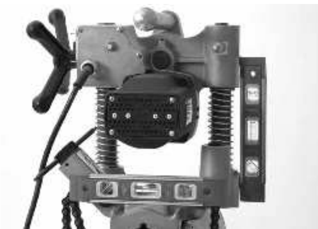
10. ábra – A HC-300 kiszintezése
