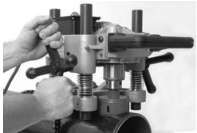
Figura 11 – Perforadora en funcionamiento
