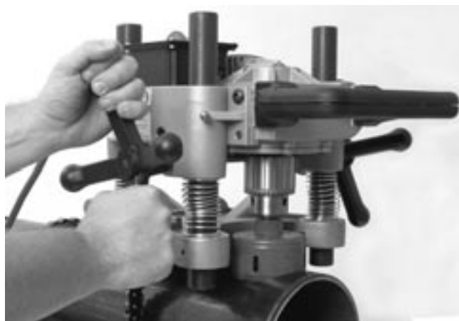
Figura 11 – Perforadora en funcionamiento
