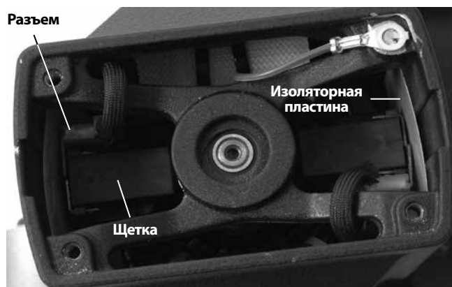
Рис. 12 – Установка щетки на двигателе со снятой крышкой
