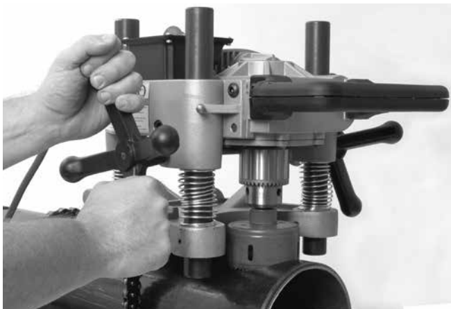
Εικόνα 11 – Χειρισμός του μηχανήματος διάτρησης σωλήνων
