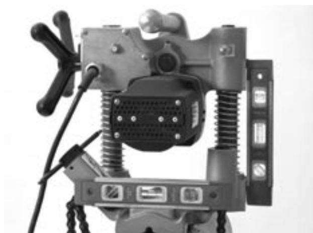
Figure 10 – Mise de niveau de la HC-300
