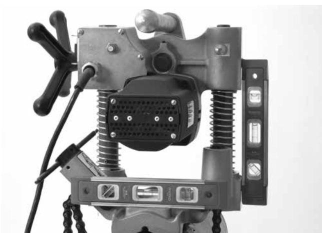
Figura 10 – Nivelamento da HC-300
