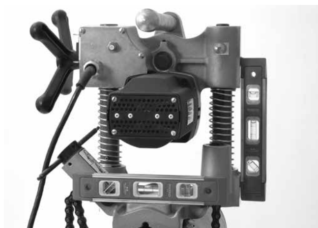
10. ábra – A HC-300 kiszintezése
