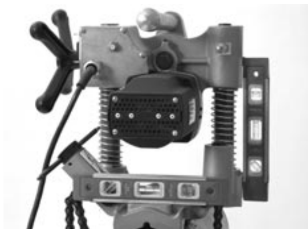
Figura 10 – Nivelación de la HC-300
