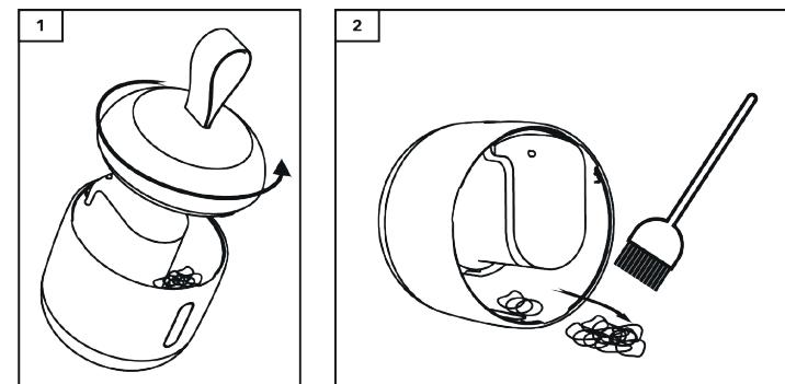
Para abrir el depósito de pelusas, gire la parte superior en sentido contrario a las agujas del reloj (imagen 1) y extrágala. A continuación, retire las pelusas del interior (imagen 2). Asegúrese de vaciar el depósito antes de que llegue al 80% de su capacidad.
