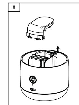
2. Rimuovere il coperchio superiore del dispositivo (fig. 7) ed utilizzare un oggetto piatto, come un piccolo cacciavite a taglio, per forzare l'apertura del coperchio della batteria (fig. 8).
