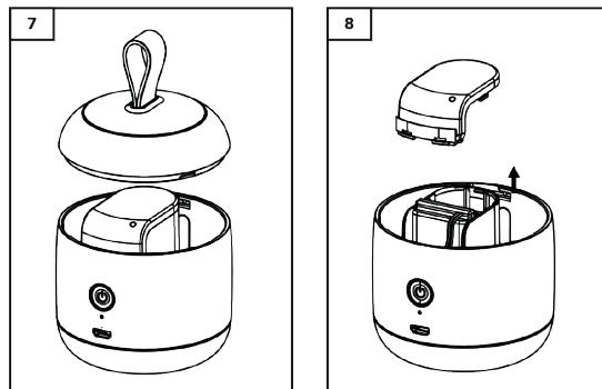
2. Entfernen Sie die obere Abdeckung des Produkts (Abb. 7) und verwenden Sie ein flaches Objekt, wie einen kleinen Flachschraubenzieher, um die Akkuabdeckung zu öffnen (Abb. 8).
