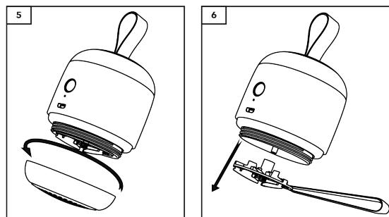
2. Bringen Sie die Klinge an, indem Sie die Kunststoffkante mit den Fingern oder einer Pinzette festhalten. Richten Sie das Loch auf der Rückseite der Klinge zum Zylinder aus und drücken Sie die Klinge in Position (Abb. 5). Setzen Sie anschließend die untere Abdeckung wieder an und schrauben sie wieder fest (Abb. 6).
