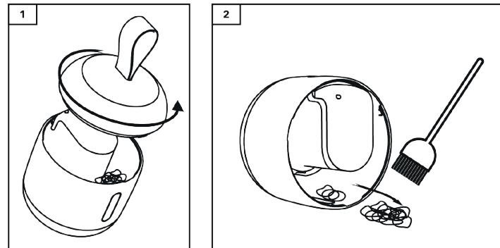
Per aprire il vano per i pelucchi, ruotare il coperchio superiore in senso antiorario (fig. 1) per poi rimuoverlo. Si possono quindi rimuovere i pelucchi all'interno (fig. 2). Assicurarsi di svuotare il vano per i pelucchi prima che sia pieno all'80%.
