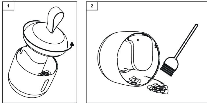
Pour ouvrir le compartiment à bouloches, tournez le couvercle dans le sens inverse des aiguilles d'une montre (fig. 1) et retirez-le. Vous pouvez ensuite retirer les bouloches qui se trouvent à l'intérieur (fig. 2). Veillez à vider le compartiment avant qu'il ne soit rempli à 80 %.
