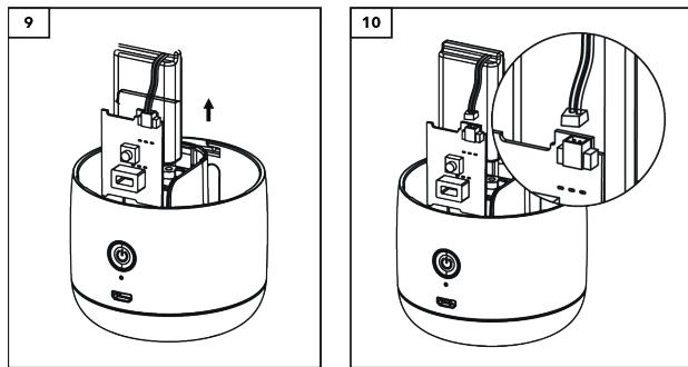
3. Retirez l'adhésif au dos de la batterie, sortez la carte de circuit imprimé et la batterie (fig. 9) et déconnectez la batterie de la carte de circuit imprimé (fig. 10). Vous pouvez maintenant retirer la batterie en toute sécurité.
