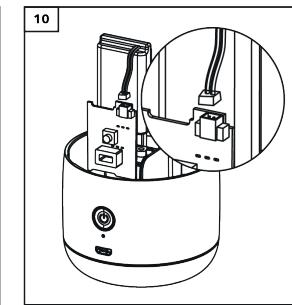
3. Rimuovere l'adesivo dalla parte posteriore della batteria, dopodiché, rimuovere il circuito stampato e la batteria (fig. 9) e scollegare la batteria dal circuito stampato (fig. 10). In questo modo, è possibile rimuovere la batteria in sicurezza.
