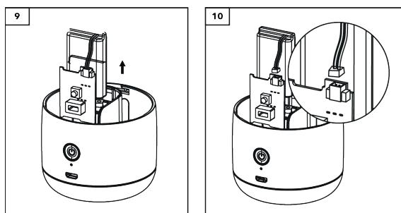
3. Entfernen Sie den Klebstoff auf der Rückseite des Akkus, ziehen Sie die Leiterplatte und den Akku heraus (Abb. 9) und trennen Sie die Verbindung zwischen Akku und Leiterplatte (Abb. 10). Nun können Sie den Akku sicher entfernen.
