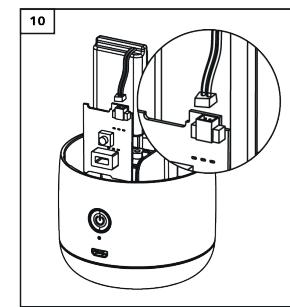
3. Retire el adhesivo de la parte posterior de la batería, extraiga la placa de circuito y la batería (imagen 9) y desconecte la batería de la placa de circuito (imagen 10). Ahora ya puede retirar la batería de forma segura.
