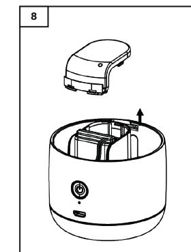
2. Retire la tapa superior del producto (imagen 7) y utilice un objeto plano, como un destornillador pequeño de punta plana, para abrir la tapa de la batería (imagen 8).
