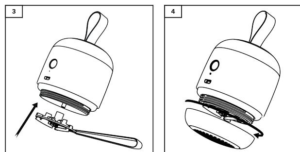
1. Rimuovere le lame ruotando il coperchio inferiore in senso orario (fig. 3) fino a svitarlo completamente. Tenere con le dita o con delle pinzette la parte in plastica delle lame e tirare delicatamente verso il basso per rimuovere le lame (fig. 4).
