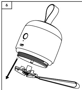
2. Montare le lame tenendo con le dita o con delle pinzette la parte in plastica delle lame. Allineare il foro sulla parte posteriore delle lame con il cilindro e premere per mettere in posizione le lame (fig. 5). Dopodiché, riavvitare il coperchio inferiore (fig. 6).
