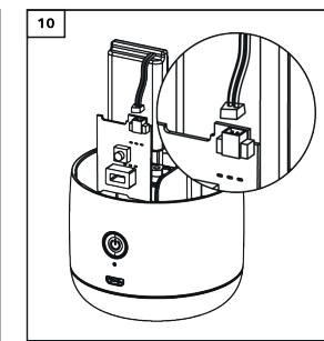
3. Remova o adesivo da parte de trás da bateria, puxe o disjuntor e a bateria para fora (fig. 9) e desligue a bateria do disjuntor (fig. 10). Agora, pode remover a bateria em segurança.
