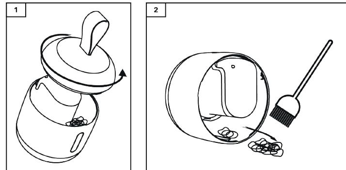
Para abrir o compartimento de borbotos, rode a parte superior para a esquerda (fig. 1) e retire-a. Poderá, então, remover o borboto que se encontrar no interior (fig. 2). Certifique-se de que esvazia o compartimento de armazenamento antes deste atingir os 80% de capacidade.
