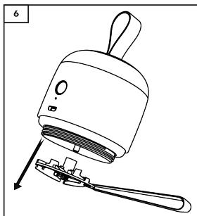
2. Coloque la cuchilla sujetando su borde de plástico con los dedos o con unas pinzas. Alinee el orificio de la parte posterior de la cuchilla con el cilindro y presiónela hasta que quede bien encajada (imagen 5). Luego, vuelva a colocar la cubierta inferior y vuelva a enroscarla (imagen 6).
