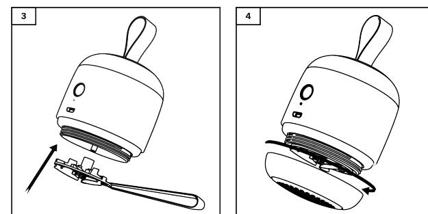
1. Retire la cuchilla girando la cubierta inferior en sentido de las agujas del reloj (imagen 3) hasta que esté completamente desenroscada. Sujete el borde de plástico de la cuchilla con los dedos o con unas pinzas y tire de él ligeramente hacia abajo para extraer la cuchilla (imagen 4).
