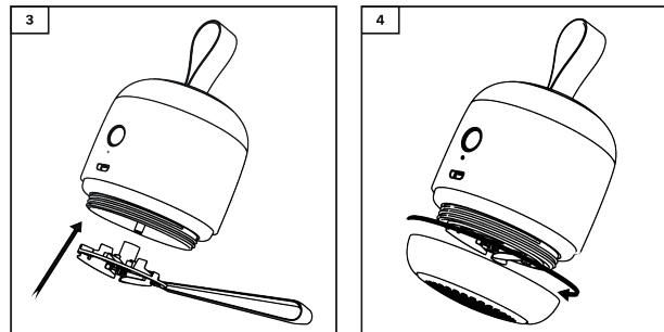
1. Entfernen Sie die Klinge, indem Sie die untere Abdeckung im Uhrzeigersinn drehen (Abb. 3), bis sie vollständig abgeschrägt ist. Halten Sie die Kunststoffkante der Klinge mit den Fingern oder einer Pinzette fest und ziehen Sie sie leicht nach unten, um die Klinge herauszuziehen (Abb. 4).
