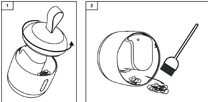
Um das Flusenfach zu öffnen, drehen Sie seine Oberseite gegen den Uhrzeigersinn (Abb. 1) und nehmen sie ab. Anschließend können Sie das Innere des Flusenfachs herausnehmen (Abb. 2). Achten Sie darauf, das Fach zu leeren, bevor es zu 80 % voll ist.
