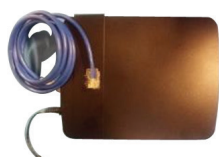
«Routeur externe et câble de réseau local»
