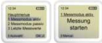
Nach dem Einschalten schaltet das Gerät automatisch in den aktiven Messmodus und im Display erscheint „Messung starten“
