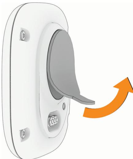
2 Conecte o cabo (extremidade ▲) na porta de carregamento.
