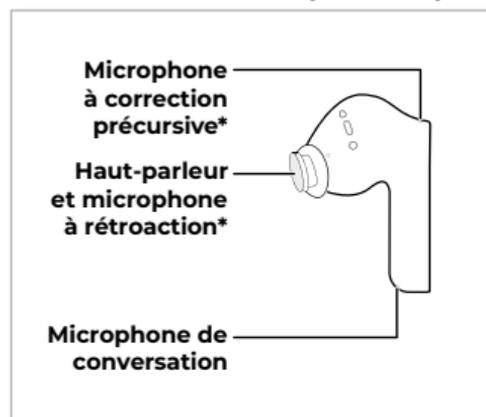
\* Les microphones à correction précurse et les microphones à rétroaction sont utilisés pour les modes de contrôle du bruit. Pour en savoir plus, consultez la section [Paramétrer les modes de contrôle du bruit](#)
