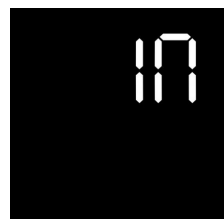
(IN) Batería interna
