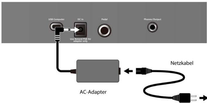
Hier wird der beige-fügte AC-Adapter angeschlossen.
