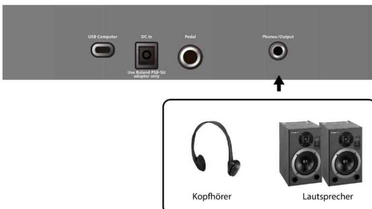
Hier können Sie einen Kopfhörer oder ein Lautsprechersystem anschließen (Anschluss: Stereo-Miniklinke).
