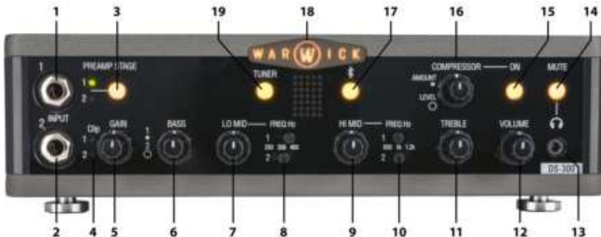
1. **INPUT 1** : Prise TS 6,35 mm (1/4") pour connecter des instruments actifs ou passifs. Lorsque vous utilisez des pédales d'effets devant l'ampli, connectez-y la sortie du dernier appareil de la chaîne de signal. Nous recommandons d'utiliser des câbles d'instrument de qualité pour obtenir les meilleures performances sonores, ainsi qu'une connexion fiable. Si seule l'INPUT 1 est utilisée, le signal est routé par le canal 1 ou 2, selon l'indicateur de canal situé à côté de l'entrée.
