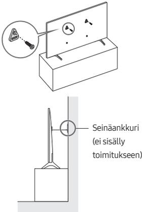
1. Kiinnitä kiinnike varmasti seinälle käyttämällä oikeita ruuveja. Varmista, että ruuvit ovat lujasti kiinni seinässä.
