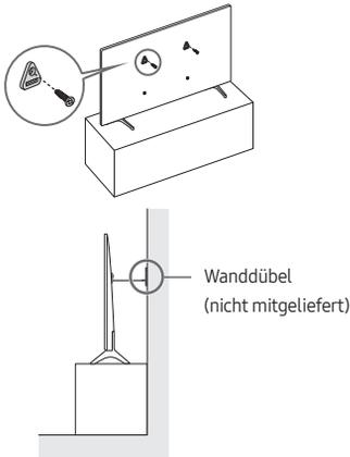
1. Befestigen Sie eine Reihe von Halterungen mit den entsprechenden Schrauben an der Wand. Vergewissern Sie sich, dass die Schrauben gut halten.
