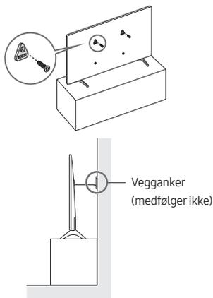
1. Bruk passende skruer til å feste et sett med braketter godt til veggen. Kontroller at skruene er godt festet til veggen.
