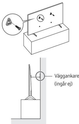
1. Fäst en uppsättning fästen ordentligt på väggen med hjälp av lämpliga skruvar. Kontrollera att skruvarna är ordentligt iskruvade i väggen.
