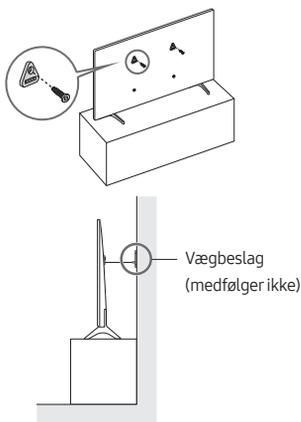
1. Sådan fastgør du et sæt af beslag sikkert til væggen ved hjælp af de korrekte skruer. Bekræft, at skruerne sidder godt fast i væggen.
