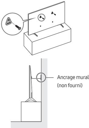
1. Fixez solidement des supports au mur à l'aide de vis adaptées. Assurez-vous que les vis sont fermement fixées au mur.
