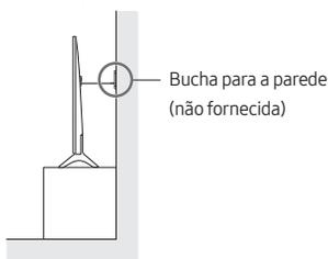
1. Utilizando os parafusos adequados, fixe bem um conjunto de suportes à parede. Confirme que todos os parafusos estão bem fixos à parede.
