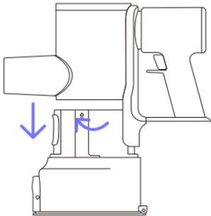
Bringen Sie den Pfeil auf der Staubkappe in Übereinstimmung mit der Entriegelungsmarkierung des Staubkappengehäuses und drehen Sie sie im Uhrzeigersinn, um sie zu verriegeln.
