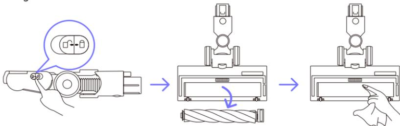
Entfernen Sie die um die Walze gewickelten Ablagerungen mit dem Powerffy Hair Cleaning Tool und spülen Sie dann mit Wasser nach.
