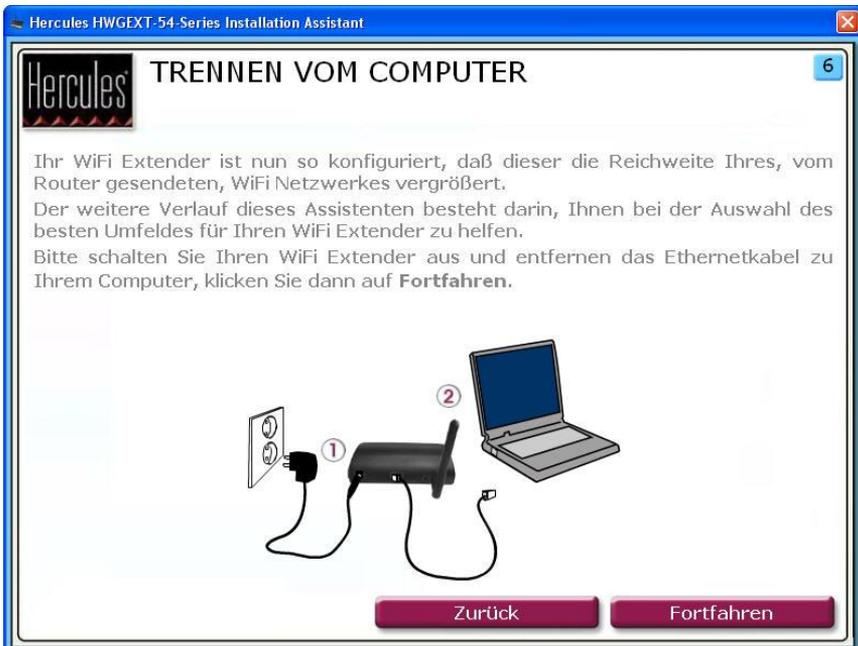
Sobald der Hercules WiFi Extender konfiguriert ist, um die Reichweite des WiFi-Netzwerks auf Ihren Wohnbereich zu vergrößern, kann der Extender vom Computer und vom Stromnetz abgetrennt werden, um anschließend am gewünschten Platz wieder installiert zu werden.
