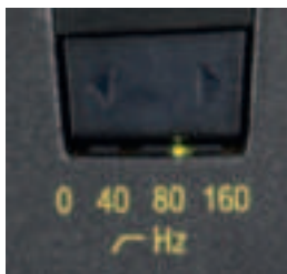
Illustration 3: Sélecteur de réduction des basses
