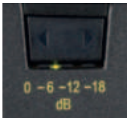
Illustration 2: Sélecteur de pré-atténuation
