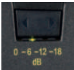
Abbildung 2: Wahlschalter für Vorabschwächung
