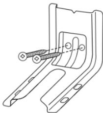
5. À l'aide d'un tournevis à tête cruciforme et des 2 vis n° 12 x 1 5/8 po (4,1 cm) fournies, visser la bride antibasculement au mur ou au plancher.
