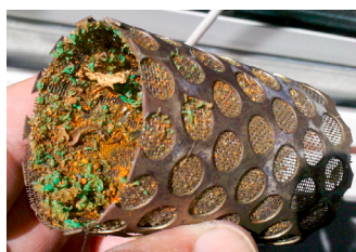
Figura 9. Filtro tipo "Y" e filtro tampado com sujeira
