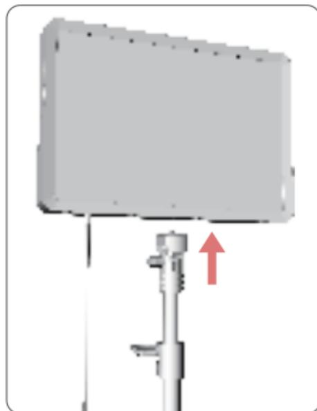
② La base de la luz se conecta a la pieza de tornillo de 1/4" ubicada en la parte superior del soporte de la luz girando la pequeña rueda. Esto debe hacerse con cuidado para evitar enhebrar.
