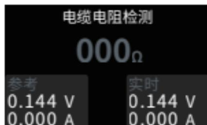
使用压差法测量线缆内阻，需要配合恒流负载使用。
