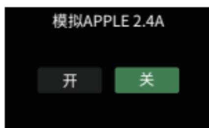
苹果设备在检测到充电头D+及D-为2.7V的时候才能以5V-2.4A充电，开启之后，此功能将D+及D-设置为2.7V
