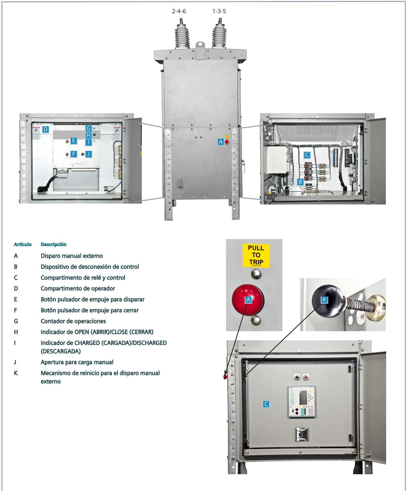
Figura 6: Relé y compartimentos de control y operador para disyuntor tipo SDV7-SE con operador de energía almacenada
