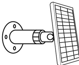
4. Lösen Sie den Einstellregler an der Halterung und stellen Sie den Winkel des Solarmoduls so ein, dass es direktes Sonnenlicht empfängt, und ziehen Sie dann den Einstellregler wieder fest, um Ihre Einstellung zu sichern.
