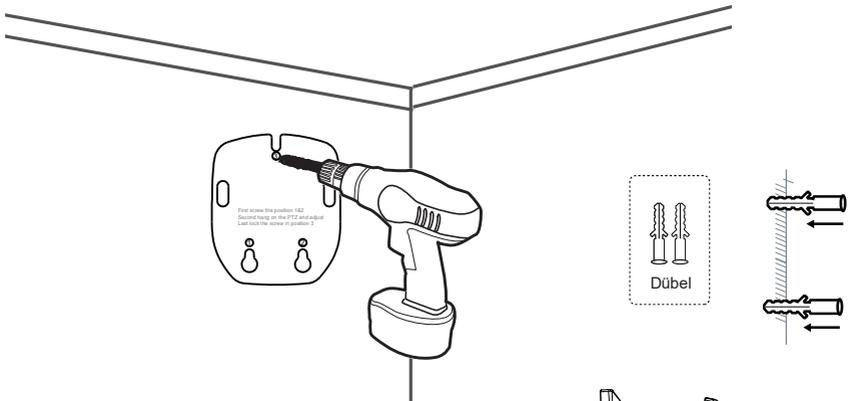
2. Befestigen Sie die Halterung mit den in der Verpackung enthaltenen Schrauben.
