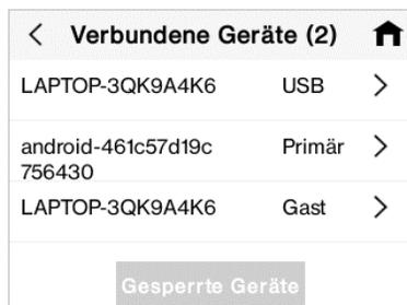
Tippen Sie auf „Gesperrte Geräte“ (Blocked Devices), um die Sperre aufzuheben.
