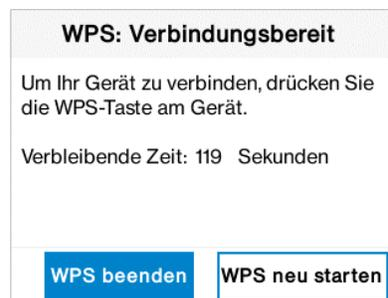
Drücken Sie die WPS-Taste am Verbindungsgerät. Bei Erfolg wird eine entsprechende Benachrichtigung angezeigt. Wurde keine Verbindung hergestellt, tippen Sie auf „WPS neu starten“ (Restart WPS) und versuchen Sie es noch einmal.
