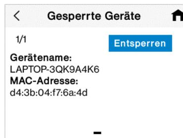
Tippen Sie auf „Entsperren“ (Unblock). Das Gerät wird aus „Gesperrte Geräte“ (Blocked Devices) entfernt und zu „Verbundene Geräte“ (Connected Devices) hinzugefügt. Wischen Sie nach links oder rechts, um ein weiteres blockierte Gerät zu finden.
