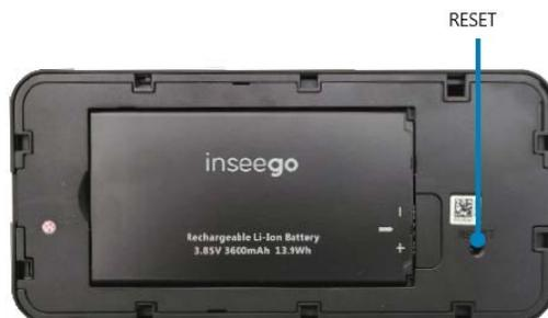
2. Führen Sie das Ende einer aufgeklappten Büroklammer in die Öffnung der **RESET**-Taste ein und drücken Sie, bis auf dem Bildschirm das **Zurücksetzen des M2000** angezeigt wird (ungefähr fünf bis sechs Sekunden). Der M2000 wird mit den Werkseinstellungen neu gestartet.
