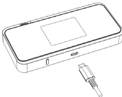
2. Schließen Sie das andere Ende des USB-Kabels an das Schnellladegerät an und schließen Sie das Ladegerät an eine geeignete Steckdose an.
