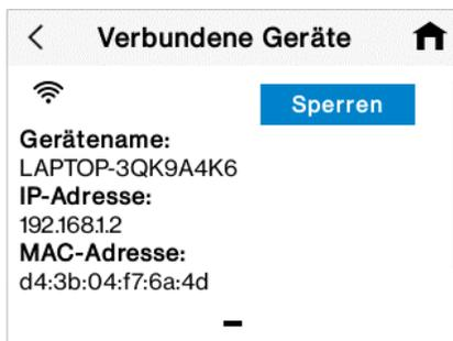
Tippen Sie auf „Sperren“ (Block), um ein Gerät zu blockieren.
