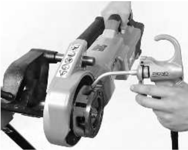
Abbildung 14 – Gewindeschneiden in Rohr
