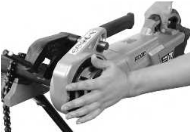
Abbildung 13A - Gewindeschneiden mithilfe der Schneidkopfabdeckplatte starten
