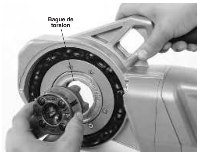
Figure 8 – Installation des têtes de filière 760 FXP 11-R d'un maximum de 1 1/4"
