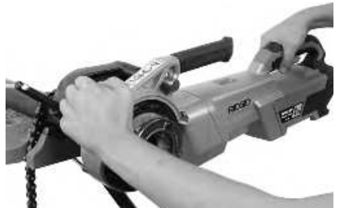
Abbildung 13B - Gewindeschneiden mithilfe des Druckkissens starten
