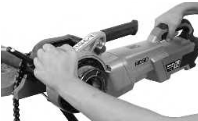
Figura 13 B – Iniciar el roscado al presionar la placa de empuje
