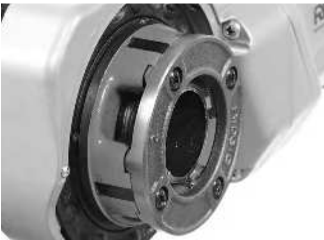
Abbildung 15 – Rohr fluchtet mit Kante der Schneidbacken
