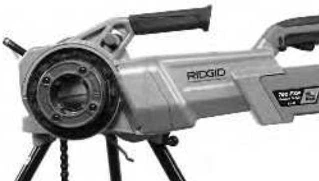
Abbildung 11 - Richtige Ausrichtung des 760 FXP Kraftantriebs
