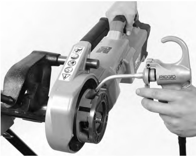
Abbildung 14 – Gewindeschneiden in Rohr
