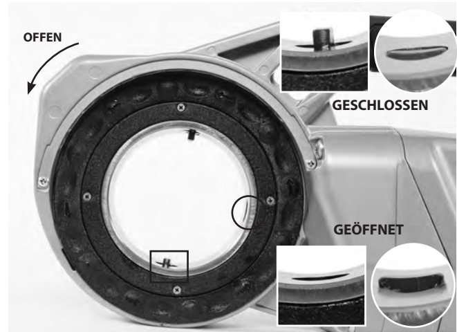
Abbildung 6A - Haltemechanismus (760 FXP 12-R)
