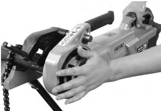
Abbildung 13A - Gewindeschneiden mithilfe der Schneidkopfabdeckplatte starten
