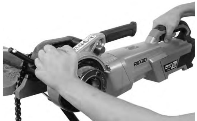
Figure 13B – Entame de filetage à l'aide du patin d'appui
