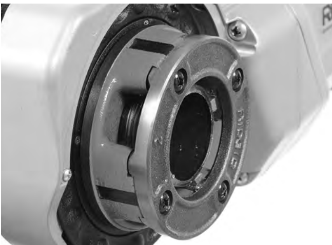
Abbildung 15 – Rohr fluchtet mit Kante der Schneidbacken
