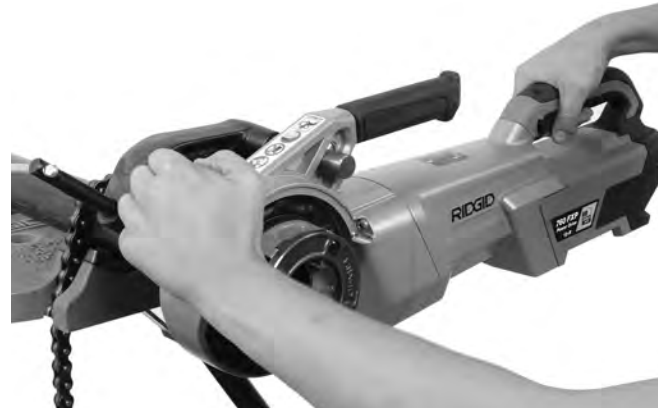
Abbildung 13B - Gewindeschneiden mithilfe des Druckkissens starten
