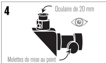
**4** Regardez dans l'oculaire de 20 mm dans le télescope. Faites tourner doucement la molette de mise au point pour ajuster la netteté de l'image.
