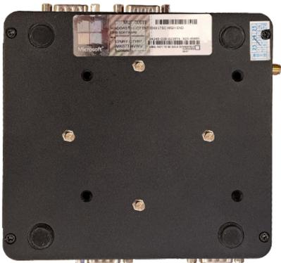
Figura 6: Parafusos de Montagem
