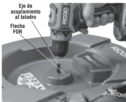
Figura 4 – Conexión del taladro al eje de acoplamiento
