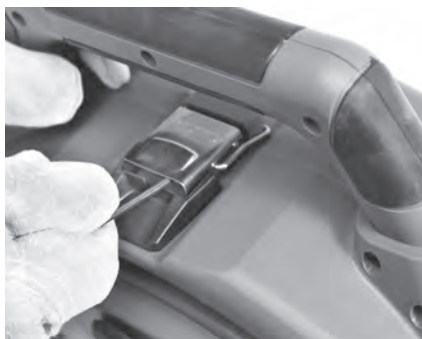
Abbildung 14 – Verschluss unter dem Tragegriff öffnen (mit Sechskantschlüssel)
