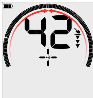
Signal cible le plus fort: Tous les segments de discrimination sont activés (On). La cible est située directement sous la ligne centrale de la bobine.
