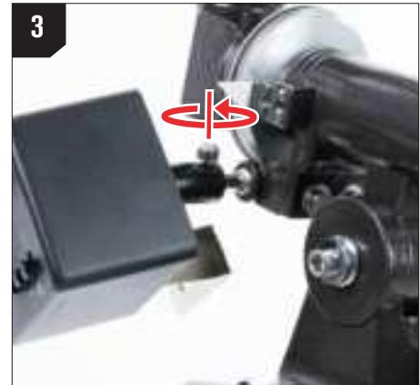
Serrez la vis du coupleur sur le côté plat de l'arbre à l'aide d'un tournevis plat (non fourni).
