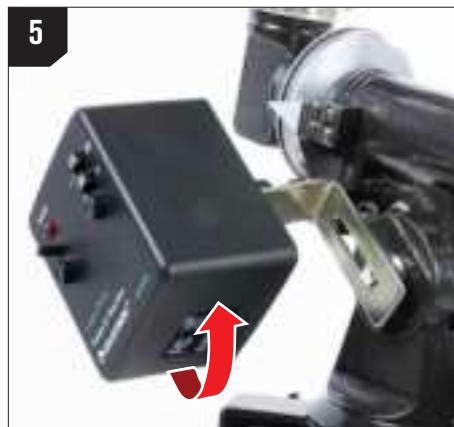
Alignez le trou oblong du support moteur avec le trou fileté où se trouvait la vis Allen. Si nécessaire, faites pivoter l'arbre à vis sans fin AD en tournant le moteur d'entraînement connecté. Cela permettra de faire tourner l'arbre jusqu'à ce que le trou oblong du support s'aligne avec le trou fileté de la monture.
