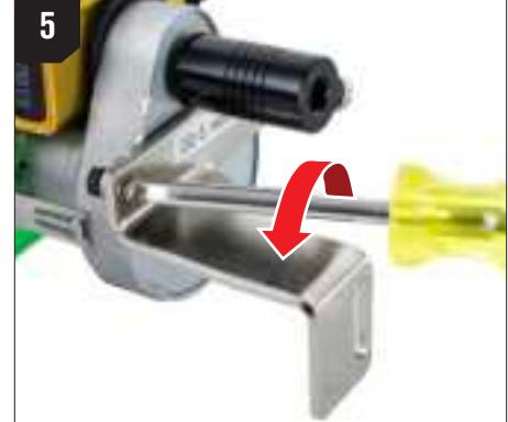
Entfernen Sie die vorhandenen Halterungsschrauben und -muttern aus dem Motorantriebsgehäuse. Seien Sie vorsichtig, die Kleinteile nicht zu verlieren – legen Sie die Schrauben und Muttern zur sicheren Aufbewahrung in einen Behälter.
