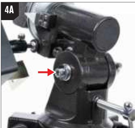
Individuare la vite a brugola da 3/8" sull'albero polare e rimuoverla con la chiave a brugola da 3/8" inclusa. Sul CG-2, si trova di fronte alla scala di latitudine.
