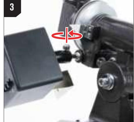
Ziehen Sie die Kupplungsschraube mit einem Schlitzschraubendreher (nicht im Lieferumfang enthalten) an der flachen Seite der Welle fest.
