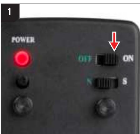
Schieben Sie den Ein/Aus-Schalter (I.) in die Position „Ein“. Eine rote LED leuchtet auf.
