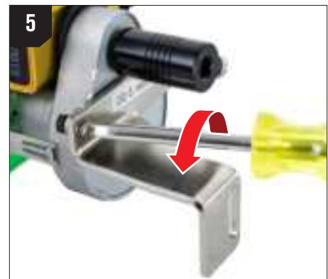
Retire los tornillos de soporte existentes y las roscas de la carcasa del impulsor motor. Tenga cuidado en no perder piezas pequeñas - guarde los tornillos y roscas en un recipiente para guardarlos.
