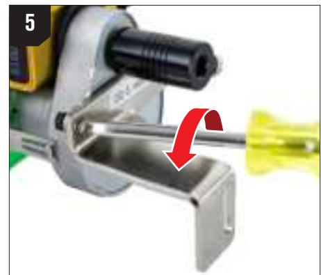
Rimuovere le viti e i dadi della staffa esistenti dall'alloggiamento del motore. Fare attenzione a non perdere i piccoli componenti: riporre viti e dadi in un contenitore per sicurezza.
