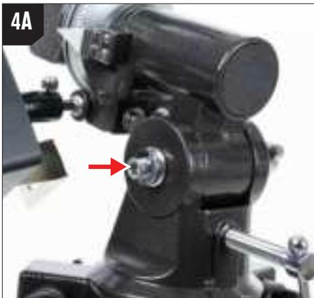
Suchen Sie die 3/8" Inbusschraube an der Polarachse und entfernen Sie diese mit dem mitgelieferten 3/8" Inbusschlüssel. Bei der CG-2 befindet sie sich gegenüber der Breitenskala.
