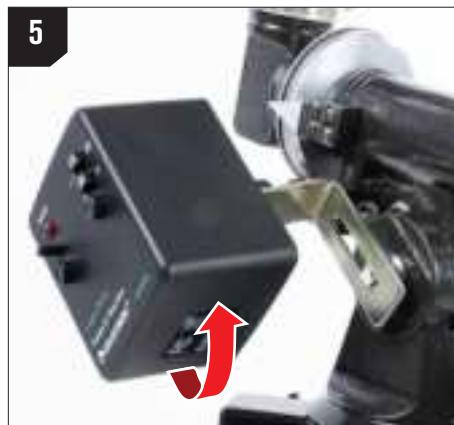
Allineare il foro asolato sulla staffa del motore con il foro filettato in cui si trovava la vite a brugola. Se necessario, ruotare l'albero della vite senza fine in AR ruotando l'azionamento del colore collegato. Questo farà ruotare l'albero fino a quando il foro asolato nella staffa non si allinea con il foro filettato sulla montatura.
