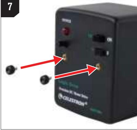
Remettez le couvercle en place et fixez-le à l'aide des vis à oreilles.
