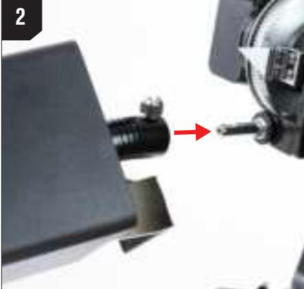
Schieben Sie das offene Ende der flexiblen Motorkupplung über die RA-Welle. Stellen Sie sicher, dass die Schraube an der Kupplung über dem flachen Abschnitt der Welle positioniert ist.
