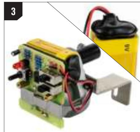
Conecte la batería al arnés cableado interior.
