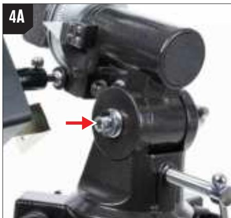
Localice el tornillo allen de 3/8" en el eje polar y retirelo con la llave allen 3/8" incluida. En el CG-2 está en el lado opuesto a la escala de latitud.
