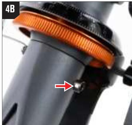
Bei der CG-3 befindet sie sich an der Seite des Polachskörpers.
