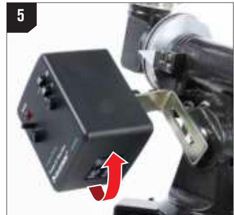
Richten Sie das Langloch an der Motorhalterung auf das Gewindeloch aus, in dem sich die Inbusschraube befand. Drehen Sie bei Bedarf die RA-Schneckenwelle, indem Sie den verbundenen Motorantrieb drehen. Dadurch dreht sich die Welle, bis das Langloch in der Halterung mit dem Gewindeloch an der Montierung übereinstimmt.
