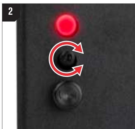
Drehen Sie den Geschwindigkeitsregler (H.) im Uhrzeigersinn, um die Geschwindigkeit zu erhöhen oder gegen den Uhrzeigersinn, um die Geschwindigkeit zu verringern.
