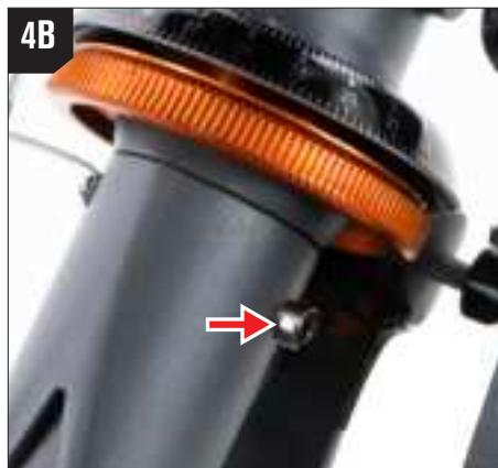
Sul modello CG-3, si trova sul lato dell'albero dell'alloggiamento polare.
