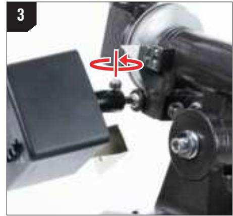
Apriete el tornillo del acople al lado plano del eje usando un destornillador de cabezal plano (no incluido).
