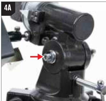
Repérez la vis Allen 3/8" sur l'arbre polaire et retirez-la à l'aide de la clé Allen 3/8" fournie. Sur le CG-2, elle se trouve en face de l'échelle de latitude.
