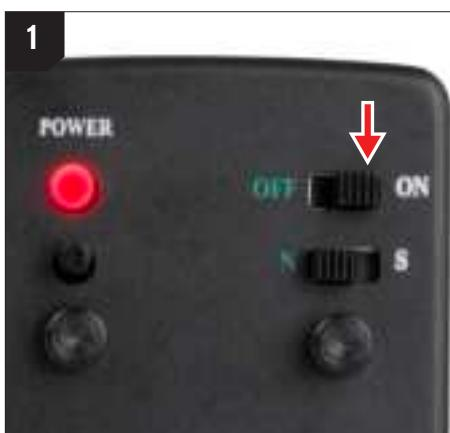
Deslice el interruptor de encendido/apagado (I) a la posición "encendido". Se encenderá un LED rojo.
