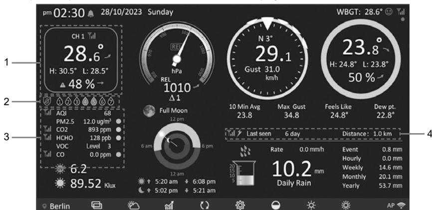
1. Sensore/i termo-igrometrico/i CH 1~7: puoi premere
