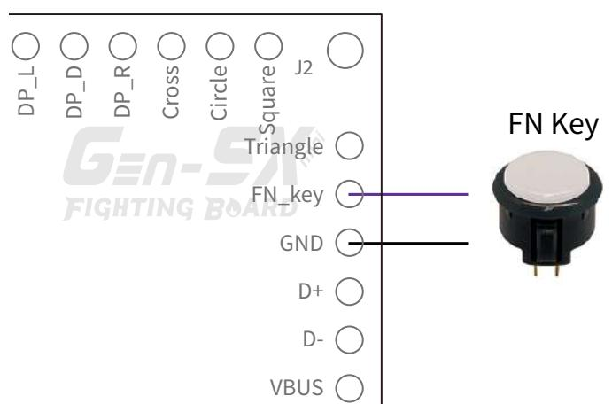
\*要使用 Turbo、RGB LED 調整及其他設定的快捷鍵操作，必須連接一個外接的 FN按鈕
