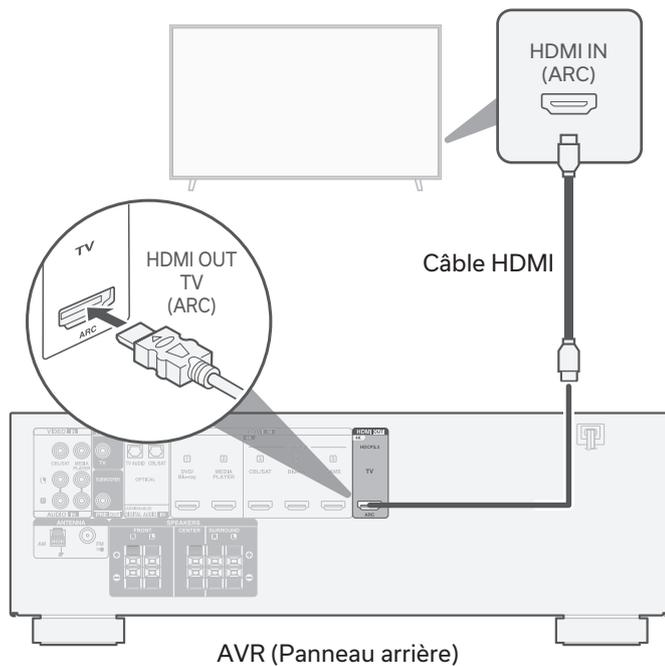
À l'aide d'un câble HDMI de haute qualité\*, connectez une extrémité au port HDMI étiqueté "ARC" sur votre téléviseur. Connectez l'autre extrémité au port HDMI OUT TV de votre AVR.
