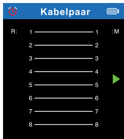
Oberfläche von Kabelpaar
