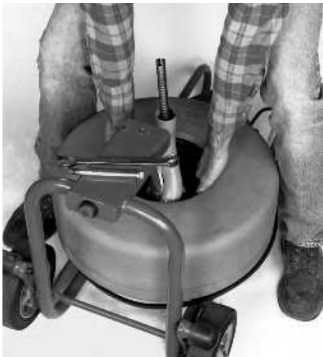
Figure 19 – Dépose du tambour
