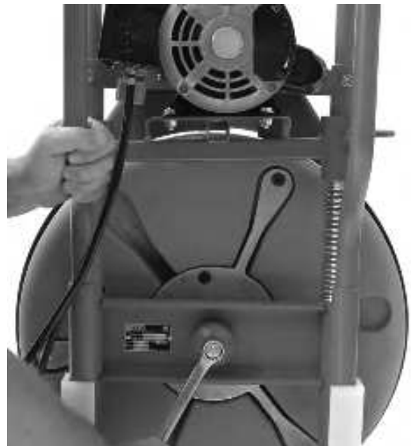
Figura 18 – Extracción del pasador del tambor
