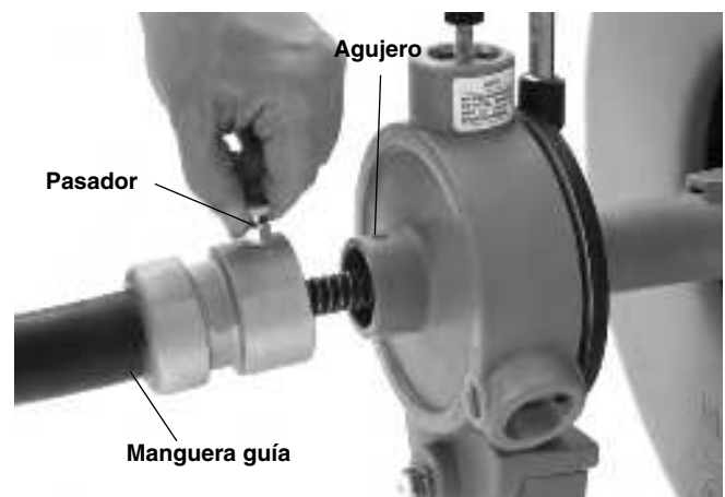
Figura 5 – Conexión de la manguera guía frontal al AUTOFEED
