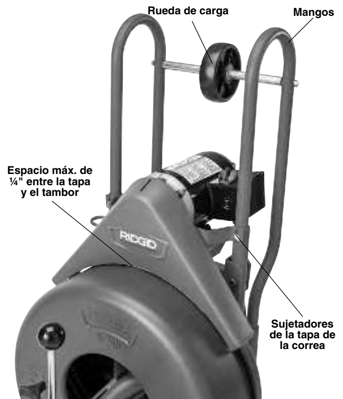
Figura 3 – Instalación de los mangos y ajuste de la tapa de la correa
