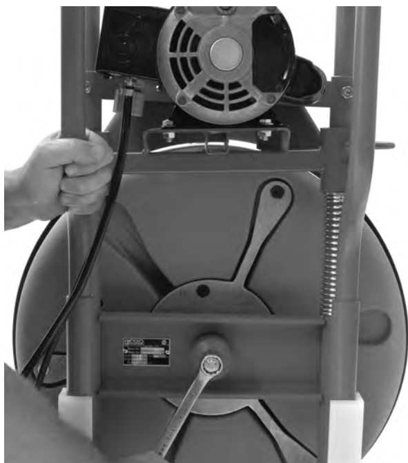
Figure 18 – Retrait du boulon du tambour
