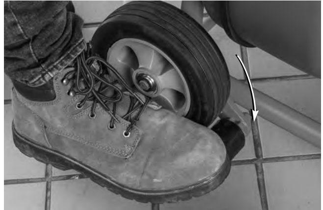
Figura 11 – Montaje de las patas de soporte
