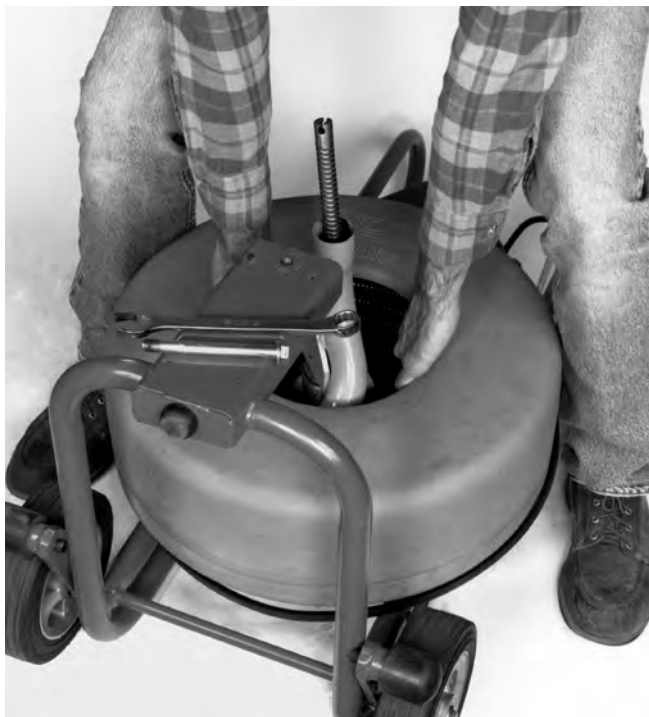
Figure 19 – Dépose du tambour
