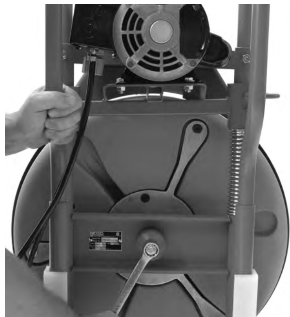
Figura 18 – Extracción del pasador del tambor
