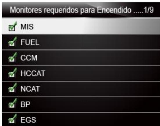
Figura 5-9 muestra pantalla de selección de monitores requeridos para encendido por Compresión.
