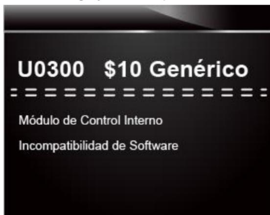
Figura 4-5 muestra pantalla descripción de DTC (código de falla)
