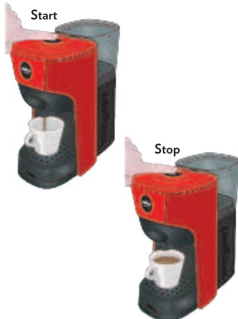
**⚠** Se durante l'erogazione si esaurisce l'acqua all'interno del serbatoio la macchina **NON** si ferma. Accertarsi che il serbatoio sia sempre pieno prima di iniziare l'erogazione.
