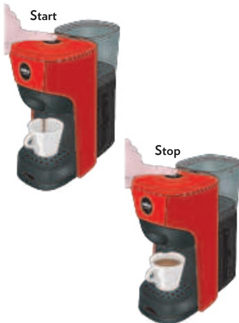
**A** Si mientras se dispensa se agota el agua del depósito, la máquina **NO** se detiene.
