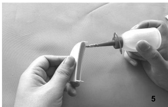
Bild 5 – Tragen Sie den Kleber auf die Servoabdeckungen auf.
