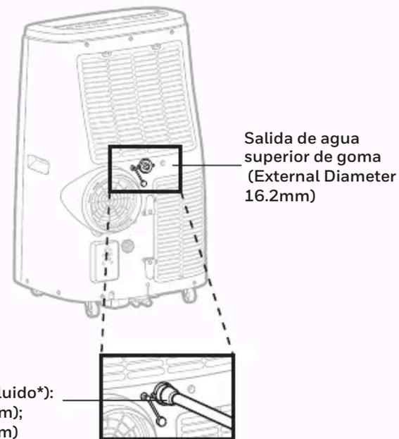
**IMPORTANTE:** NO se recomienda conectar el tubo de drenaje para un drenaje continuo si la unidad está encendida en el modo de aire acondicionado, ya que podría reducir la eficiencia de refrigeración del aire acondicionado portátil. Drene solamente el agua condensada cuando la unidad esté apagada. El drenaje continuo solo es apropiado cuando la unidad está en el modo de deshumidificación.
