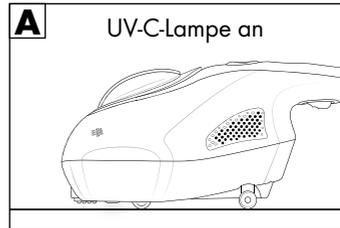
Verlieren die Sicherheitsschalter den Kontakt zum Untergrund, wird die Abschaltautomatik aktiviert und die UV-C-Lampe ⑧ hört auf zu leuchten (Abb. B und C).
