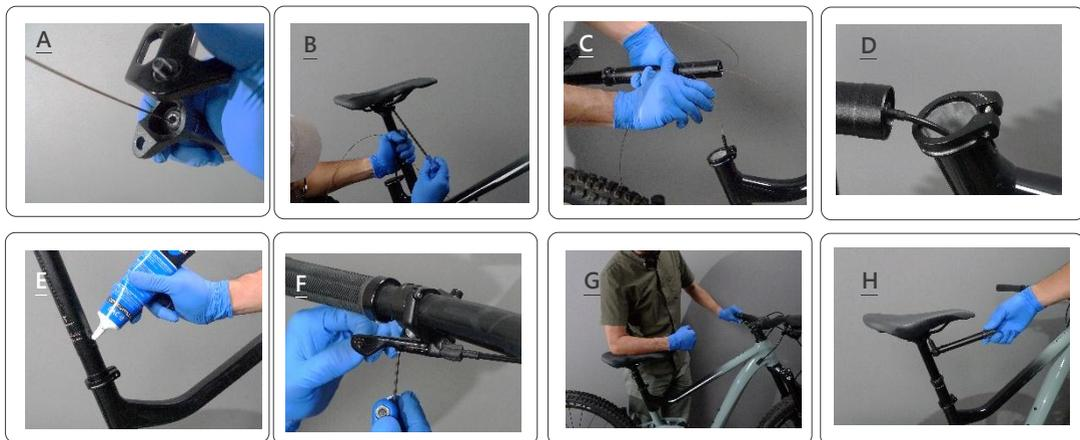
1. (Saltare al punto 2 se si sta montando una nuova bicicletta) Rimuovere il reggisella e la sella esistenti dalla bicicletta prima di installare il GIANT CONTACT SWITCH SL.
